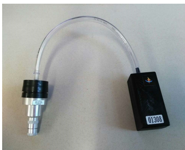
Figure A.2 – Photographies du dispositif de mesure de l'exposition aux particules fines (à droite : porté par une enquêtrice).
